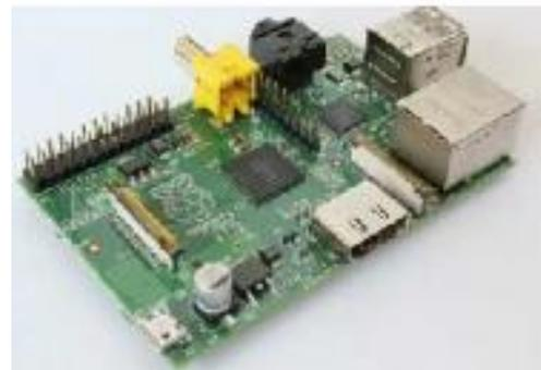
**Fig.3.1. Raspberry pi controller.**
